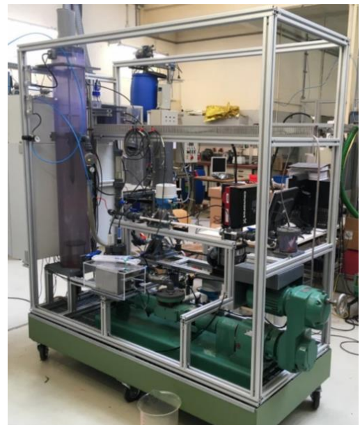
Abb. 1: Bioreaktor mit trocken aufgestellter Membran
